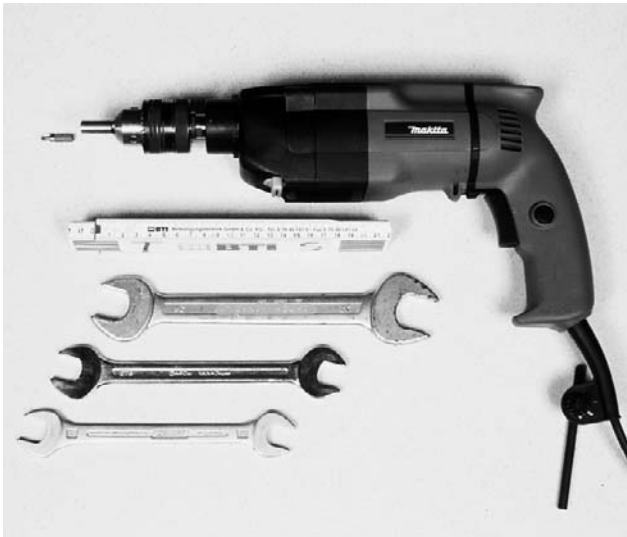
Bild 13 Montage-Werkzeug: Zollstock, Bohrmaschine, Kreuzschlitz-Bit PZ3, Maulschlüssel in den Größen 16, 19 und 24
