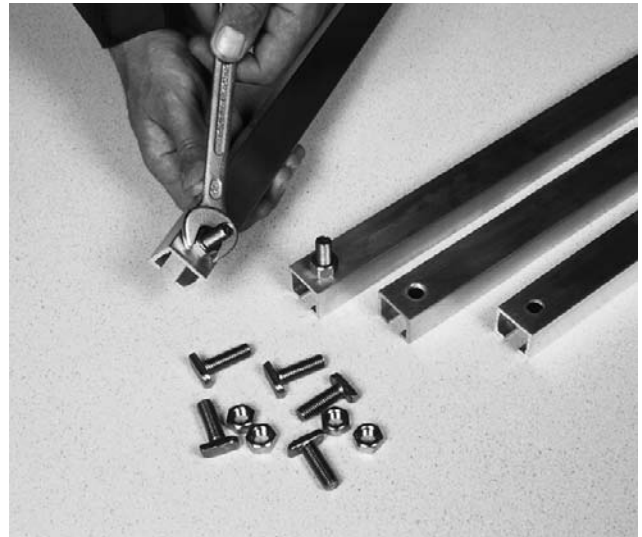
Bild 14 Montageschienen am Boden vorbereiten. Zunächst in alle Bohrungen der Montageschienen von der Innenseite Hammerkopfschrauben stecken und die Muttern festziehen.
