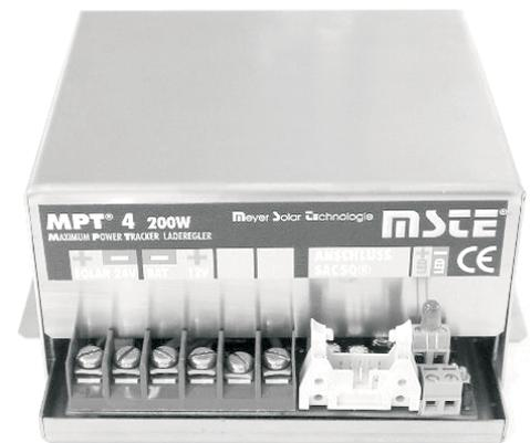
Die höhere Arbeitsspannung von ca. 25 – 40V eines Moduls in 24 V Technik wird durch den **MPT®4** Laderegler herunter transformiert auf die Batteriespannung 11 – 14V. Dadurch steigt der Ladestrom entsprechend an. Zusätzlich hinzu kommt der gewonnene Ladestrom durch die MPPT Technik.
