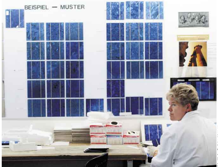
Die guten ins Töpfchen: Per Handauslese trennen die Hersteller – hier Q-Cells in Thalheim – die einwandfreien Zellen von solchen mit mehr oder minder großen Fehlern. Verkaufen können sie derzeit praktisch alles.
