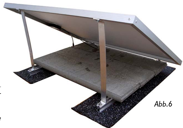
Abb.5 Schienen laufen mit der langen Modulseite. Die Gewichtslast liegt unter den Schienen als einzelne Betonelemente oder als durchgehender Rasenkantenstein. Zusätzliche Steine können dann ohne Verschraubung im Kreuzverbund aufgebracht werden.
