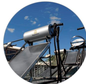
SECUterm auf dem Prüfstand des Testzentrums Saarbrücken
