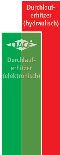
Die energiesparende Elektronik der neuen Durchlauferhitzer sorgt für 20 % weniger Energie- und Wasserverbrauch gegenüber herkömmlichen hydraulischen Durchlauferhitzern.
