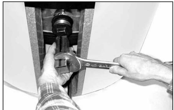
Zur Öffnung der 2"-Muffe einen Steckschlüssel oder ggf. eine Verlängerung verwenden (Vierkantprofil z. B. 35 x 35, notwendige lichte Weite: mind. 26 x 26)
