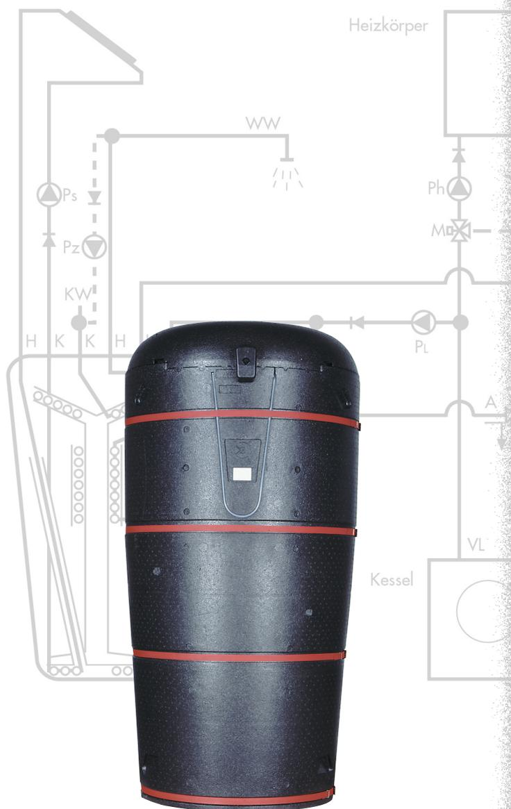
Der **CONUS 502** speichert effizient die von Sonnenkollektoren aufgefangene Wärme. Durch die patentierte **Consolar-Schichtenleittechnik** steht solar aufgeheiztes Speicherwasser sofort der Warmwasserbereitung oder auch der Heizungsunterstützung zur Verfügung. In einem hocheffizienten Kupfer-Wärmetauscher wird Trinkwasser hygienisch im Durchlauf erwärmt. Die Gefahr der Legionellenverkeimung ist dadurch ausgeschlossen.
