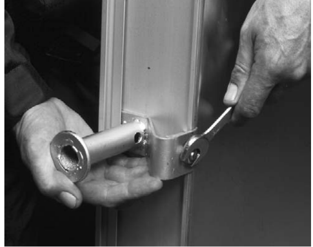
Bild 12 Tragegriffe liefern wir auf Wunsch. An beiden Seiten des Kollektors mit Befestigungsklemme - höheren Absatz zum Kollektor - festschrauben. Sicherer Halt überprüfen!
