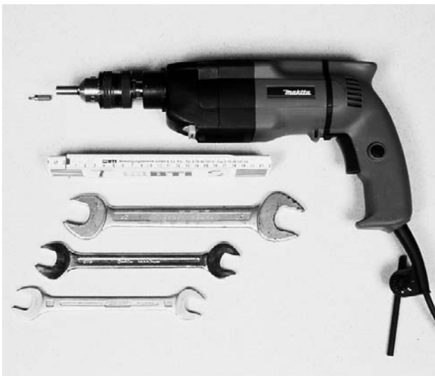
Bild 9 Montage-Werkzeug: Zollstock, Bohrmaschine, Kreuzschlitz-Bit PZ2, 3 und Maulschlüssel in den Größen 16, 19, 24 sowie Hammer, Teppichmesser und Silikonspritze (ggf. Flex mit Steinscheibe).
