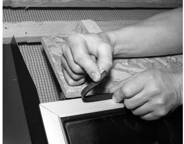
Bild 30 Auf den Kollektorrahmen oben dünnes Zellgummiband kleben.
