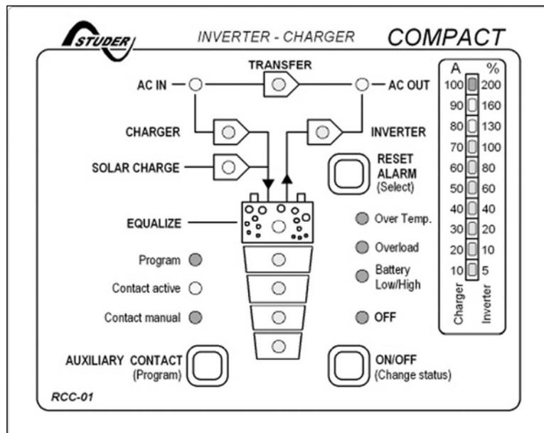
Der Steuereingang ist parallel zur ON/OFF-Taste geschaltet. Mit einer Impulstaste oder einem Impulskontakt kann über diesen Eingang der XP-COMPACT ein- bzw. ausgeschaltet werden.
