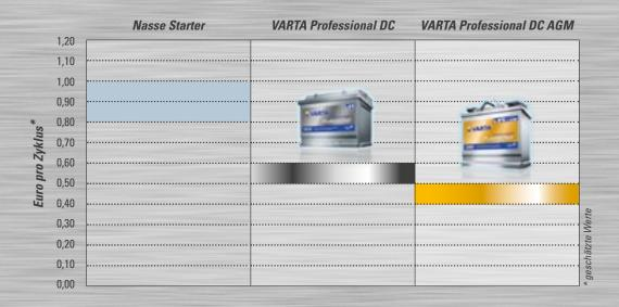
Es zahlt sich aus, wenn Sie eine Batterie mit hoher Zyklenfestigkeit wählen, denn die Zyklenfestigkeit ist entscheidend für die Lebensdauer der Batterie.
