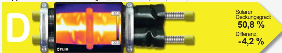
Rohre, 13 mm Dämmung,  $\lambda_{40^\circ} = 0,045 \text{ W/mK}$  (0,042)
