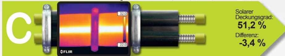
Doppelrohr, 14 mm Dämmung,  $\lambda_{40^\circ} = 0,045 \text{ W/mK}$  (0,042)
