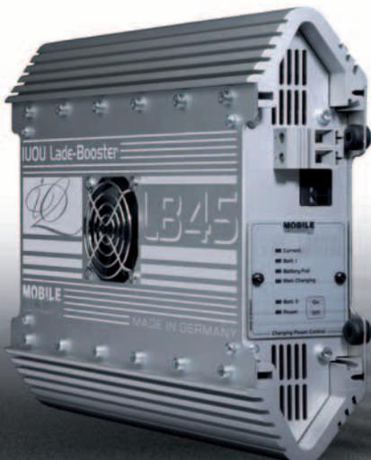
In zwei Leistungsstufen (25A und 45A) erhältlich, garantiert er die optimale und schnelle Ladung auch während der Fahrt. Die IUOU-Ladekennlinien sorgen dafür, dass der Ladestrom von der Lichtmaschine auf die Werte angehoben wird, die für den jeweiligen Batterietyp zur Vollladung von den Batterieherstellern gefordert sind.
