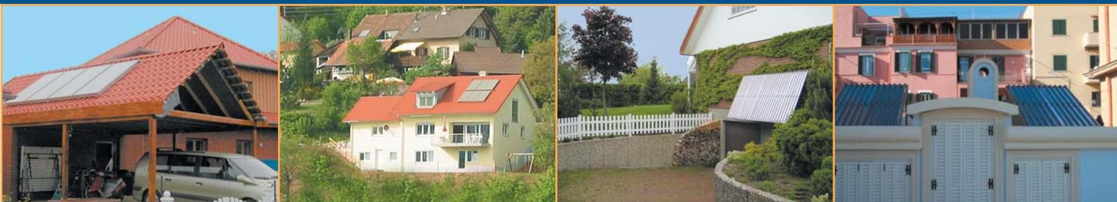
Verschiedene Formen der Kollektormontage: Aufdach-, Fassaden- und Flachdachmontage
