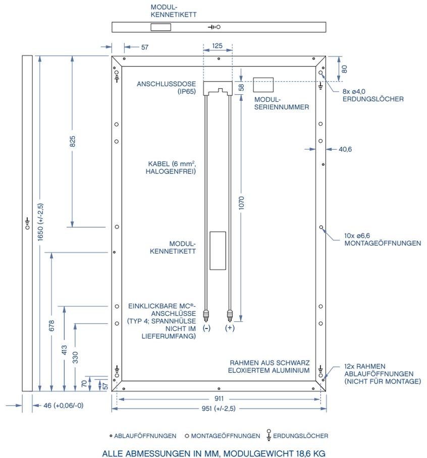
Die obige Abbildung ist eine grafische Darstellung des Produkts. Technische Zeichnungen können Sie bei Evergreen Solar anfordern. MC<sup>2</sup> ist eine eingetragene Marke von Multi-Contact AG. Das Produkt wurde aus folgenden Materialien hergestellt: 114 polykristalline String Ribbon™ Silizium-Solarzellen, reflexionsabweisend beschichtetes, gehärtetes Solarglas, EVA-Vergussmaterial, Polymer-Rückseitenfolie und ein Rahmen aus doppelwandigem, eloxiertem Aluminium.
