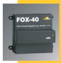
FOX-40 Derpreiswerte SolarLaderegler, idealfürkleinere Solaranlagen. SchütztlhreBatterie optimalvor Überladung. WennderLadestromfließt,leuchtetdieLED permanent.IstdieBatterievollgeladenunddie optimaleSpannungerreicht,blinktdieLED.
