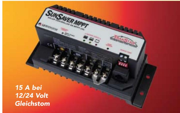
Der **SunSaver MPPT**-Solarregler von Morningstar mit TrakStar Technology™ ist ein hoch entwickeltes (MPPT) Maximum Power Point Tracking-Batterieladegerät für photovoltaisches Systeme, die nicht an ein Stromnetz angeschlossen sind. Der Regler verfügt über einen intelligenten Tracking-Algorithmus, der die Energiegewinnung aus den PV-Systemen maximiert und ein übermäßiges Entladen der Batterie mit einer Lastregelung verhindert.
