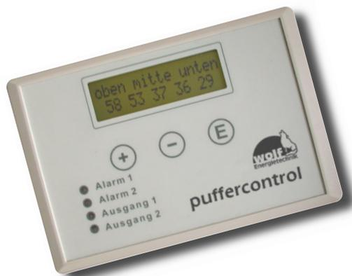
Der Puffercontrol ist eine Temperaturanzeige für Pufferspeicher, die speziell für Stückholzkessel, Holzvergaserkessel und Kaminöfen in Verbindung mit Pufferspeichern entwickelt wurde. Hier besteht oft der Bedarf den Energieinhalt des Puffers genau zu erfassen und z.B. im Wohnzimmer anzuzeigen.
