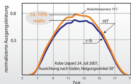
Die HIT Solarzelle und das HIT Modul haben einen sehr hohen Wirkungsgrad in Serienproduktion.
