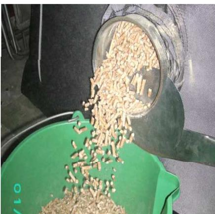
Jetzt kann Ihr fertig montiertes Holzpelletlager befüllt werden. Entnehmen Sie die Holzpellets solange über den Handschieber bis keine weiteren Holzpellets mehr über den Handschieber ablaufen ...
