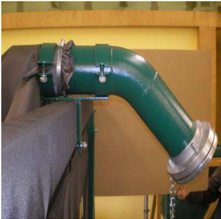
Ab einer Gestellhöhe > 2,00 m werden die Füllleitung(en) mit einem 45°-Bogen ausgestattet.
