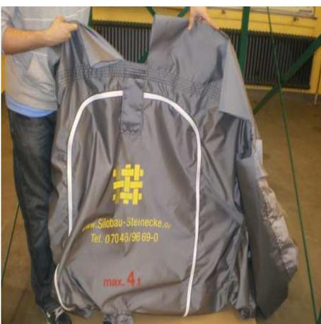
Achten Sie vor dem Einfädeln des Gewebes darauf, dass die Seite mit dem Aufdruck und dem Zugang richtig positioniert wird !
