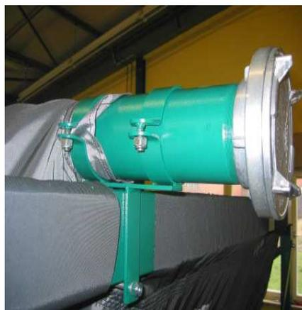
Als nächstes sind die Füllleitungen bzw. ist die Füllleitung zu montieren.
