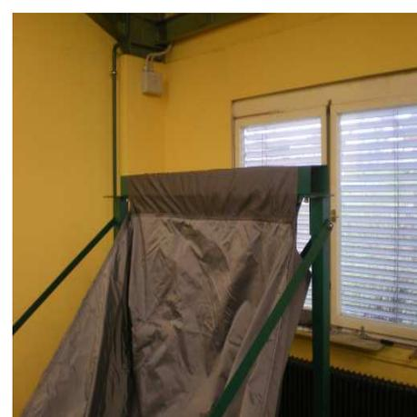
Als nächstes den hinteren Querriegel ansetzen, vorsichtig einfädeln. Den Querriegel von oben auf die Kopfstücke stecken und die Verbindung mit einer Mutter M12 sichern. Die Muttern nur noch nicht festschrauben !
