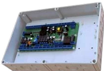
UVR1611E-NM montiert in UVR1611E-GH
