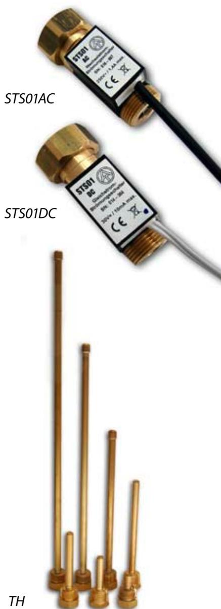
Als Detektor bei der hygienischen Warmwasserbereitung. Schaltet ab einem Volumenstrom von ca. 1,5 Liter/min., zulässiger Temperaturbereich bis -10 bis +80 °C.
