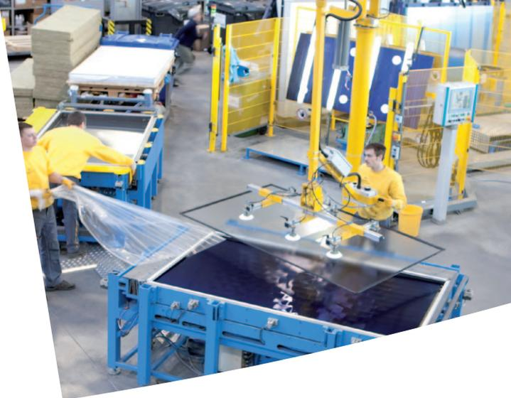
Fertigung der EURO-Kollektoren in der energieautarken Kollektorfabrik - Qualität „Made in Germany“
