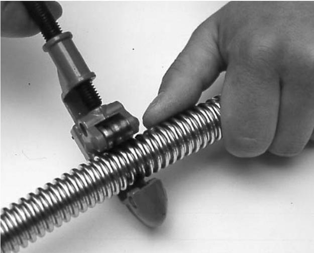
Bild 3 Edelstahlwellschlauch auf gewünschte Länge in einem Wellental plan mit einem Rohrschneider oder einer Eisensäge abschneiden. Zum Schutz der Hände und der Dichtungen Grate entfernen.
