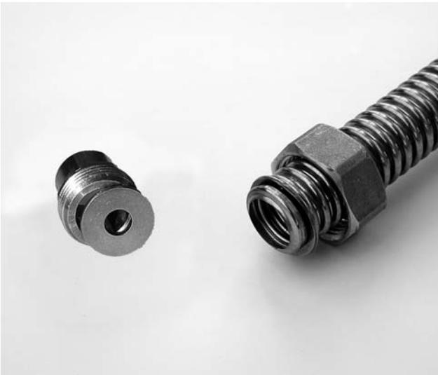
Bild 5 Jetzt wird die Welle am Rohrende zu einer Dichtfläche zusammengestaucht. Hierzu dient eine passende Unterlegscheibe, die in die Überwurfmutter eingelegt wird.
