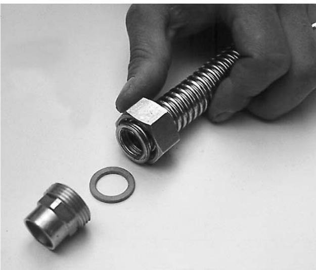
Bild 7 Wenn Sie die Verbindung endgültig zusammenschrauben, bitte Dichtung einlegen!
