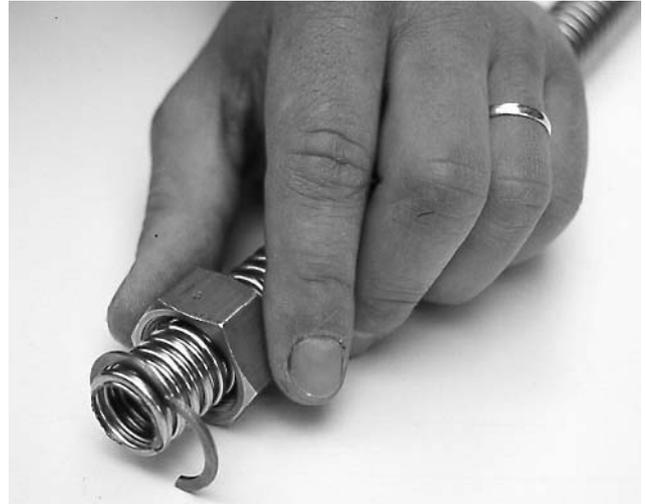
Bild 4 Überwurfmutter auf Schlauch schieben. Dann Klemmring in das erste Wellental einlegen und zusammendrücken. Wenn Sie eine Rohr- zange verwenden, Schlauch bitte nicht beschädigen.
