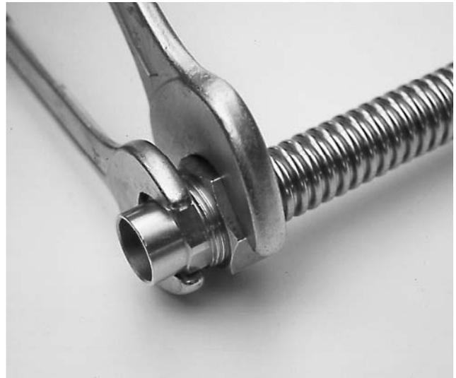
Bild 6 Überwurfmutter mit einem Schraubenschlüssel halten und Übergangsnippel fest einschrauben. Anschließend Übergangsnippel und Unterlegscheibe wieder herausnehmen.
